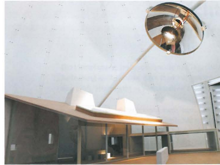
Tageslichtsimulationsmodell zum Projekt Velux Bergstraße
