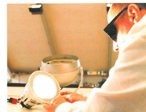
Sonderleuchten werden im Lichtlabor hinsichtlich der lichttechnischen Eigenschaften überprüft
