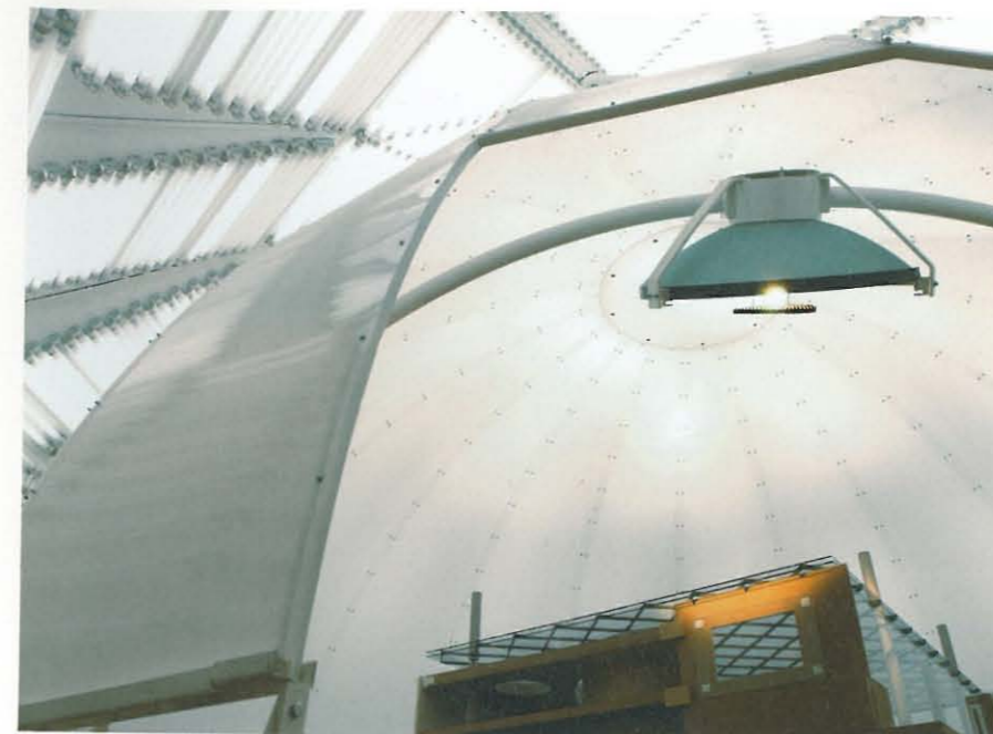
Der künstliche Himmel ermöglicht es, die tatsächliche Lichtsituation an jedem Ort der Erde zu jeder Tageszeit zu simulieren
