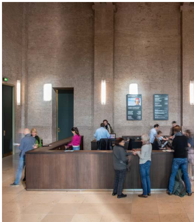
Abb.: An der frischen und trotzdem authentischen Ausstrahlung des Bauwerks hat das neue Beleuchtungssystem einen großen Anteil. Speziell entworfene Leuchten illuminieren auf angenehme Weise das großzügige Foyer mit seinen geschlammten Wänden, den hellen Jura-Kalkstein-Boden und die durch die Halle flanierenden Besucher.
