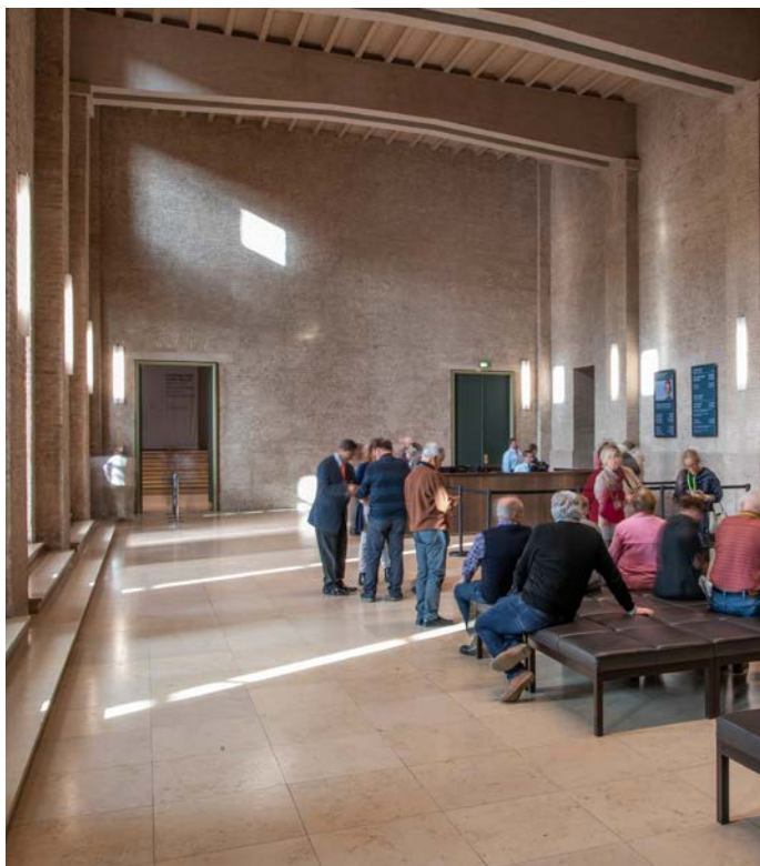
Abb.: Aus dem üblichen Betrachtungswinkel sind die Leuchten nicht sichtbar, da sie in die Unterzüge des Baus integriert wurden. Dies wurde durch eine besondere Linsentechnologie ermöglicht. Dadurch konnte auf die sonst üblichen silberfarbigen Reflektoren verzichtet werden, wodurch das Auge des Betrachters kaum abgelenkt wird.
