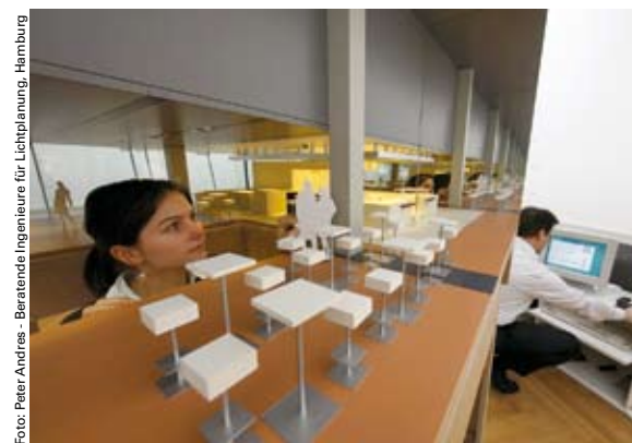
Messmodelle im Lichtlabor von Lichtplaner Prof. Andres, Hamburg: Modellsituationen liefern einen realistischen Eindruck über Licht, Raum und Material
